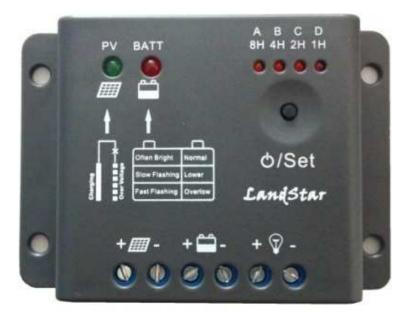
Regolatore di carica ideale per la carica controllata di batterie AGM o GEL, dotato anche di funzione crepuscolare automatica programmabile da 1 ora a 13 ore (tutta la notte) con la semplice pressione di un pulsante.
