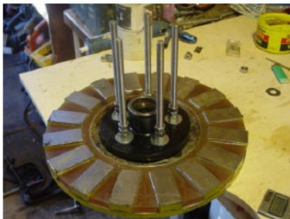
Rotore portamagneti montato su mozzo
