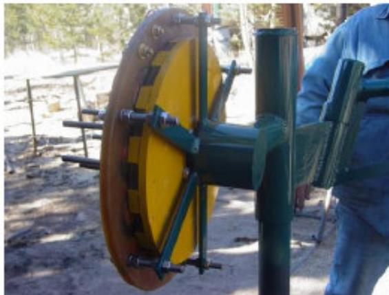
Rotore e mozzo montati a testa-palo
