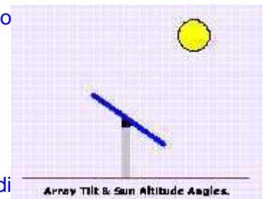
a bassa latitudine (Italia compresa, specialmente al sud), in cui il percorso del sole è mediamente più ampio durante l'anno. La rotazione richiesta a queste strutture è più ampia del tilt, spingendosi a volte fino a  $\pm 60^\circ$ . Questi inseguitori fanno apparire ogni fila di moduli fotovoltaici come uno *spiedino* orientato verso l'equatore.
