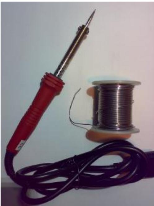
Saldatore elettrico a stagno da 30 Watt
