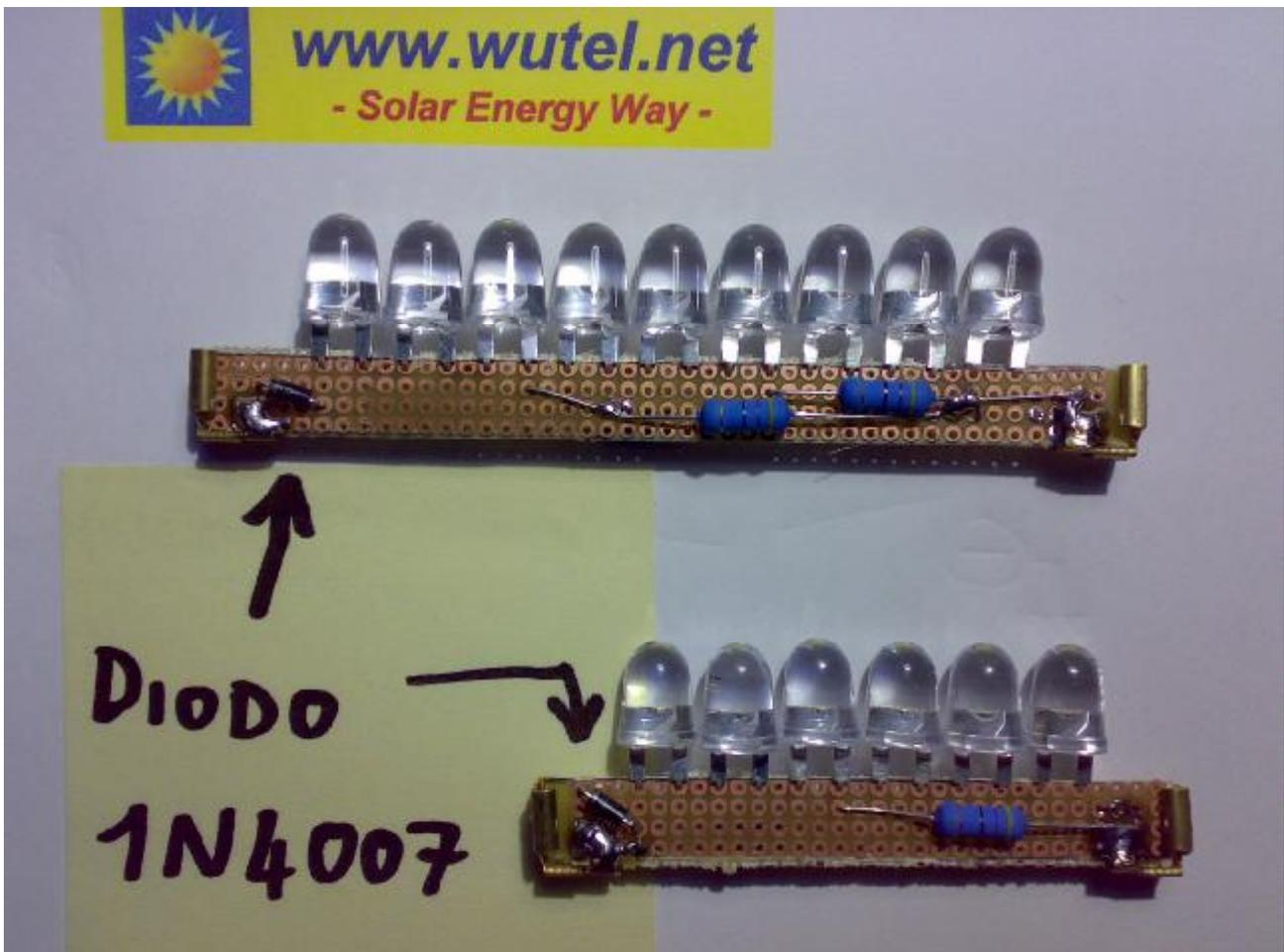
**N.B.:** nella foto non si vedono le resistenze del primo gruppo di tre led poiché sono montate sull'altra faccia del supporto "millefori".
