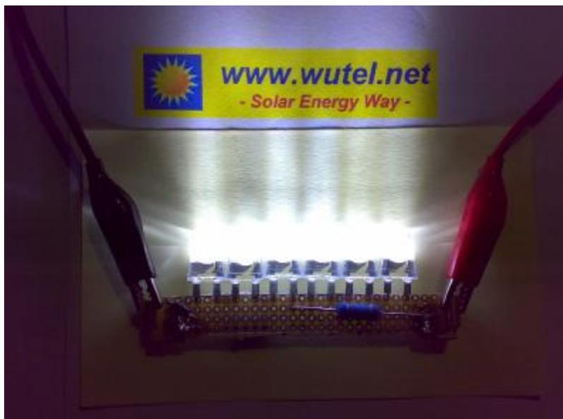
N.B.: Ricordarsi inoltre di collegare lungo la linea di alimentazione della lampada anche un fusibile di protezione di portata adeguata.
