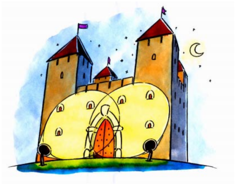
Fig. 5.10 - Corretta illuminazione dal basso di un edificio storico. Il flusso luminoso rimane contenuto entro la sagoma dell'edificio.
