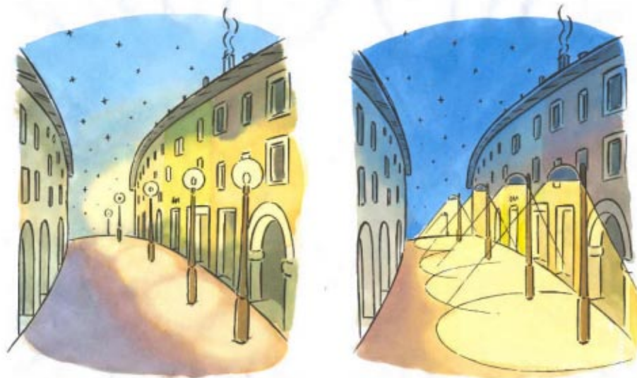
Fig. 3.7 - Lo stesso viale con illuminazione non schermata (a sinistra) e schermata. Come è più confortevole e riposante l'illuminazione di destra senza inutili abbagliamenti!
