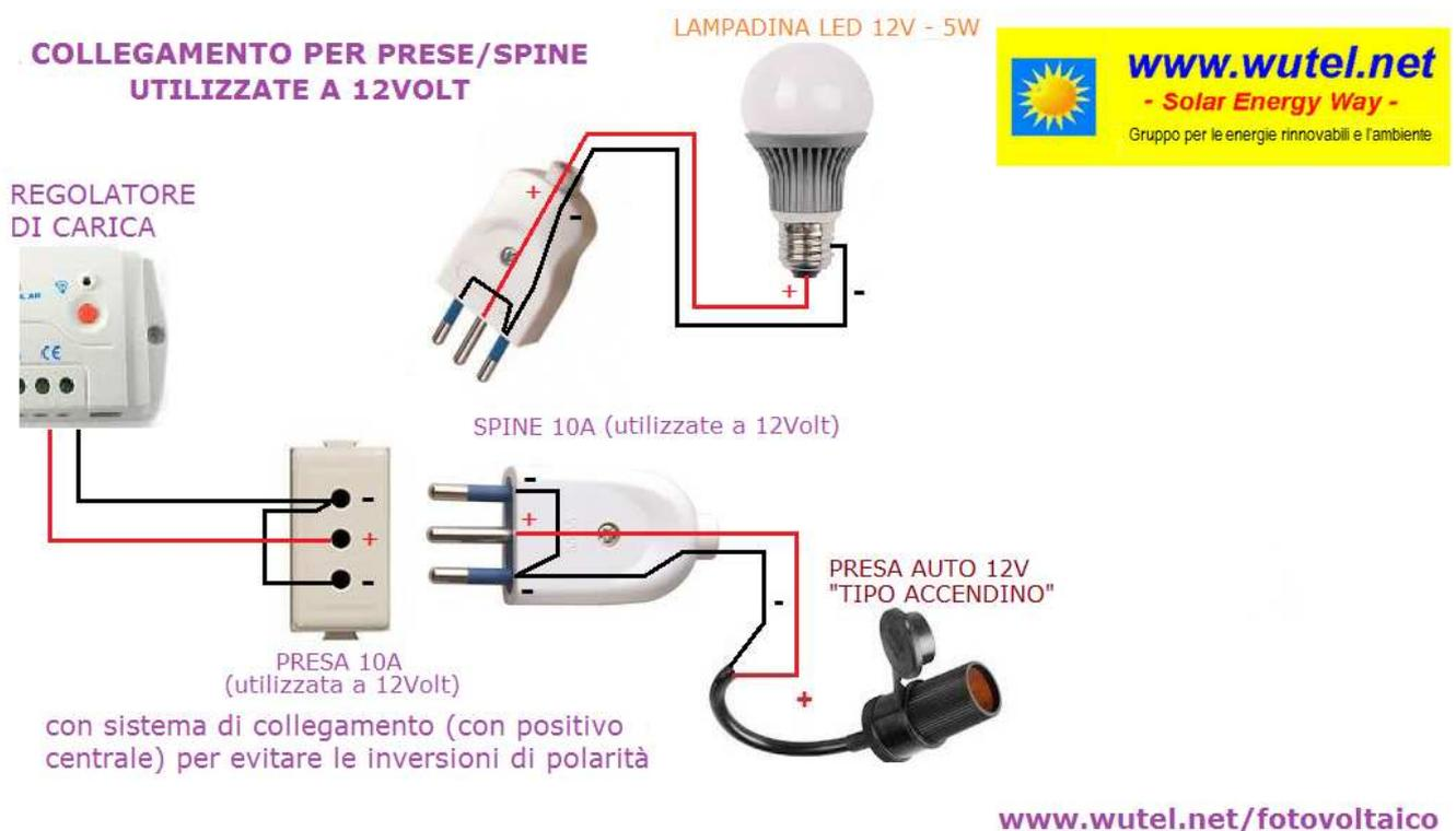
Infatti, collegando il cavo positivo (+) nel morsetto centrale della presa/spina (quello dove invece si collega di solito la terra negli impianti elettrici a 230V), e il cavo negativo (-) ai morsetti laterali (quelli dove invece si collega di solito la fase e il neutro negli impianti a 230V), non è possibile sbagliare la polarità durante il collegamento della spina alla presa, in quanto il positivo risulta sempre in centro.
