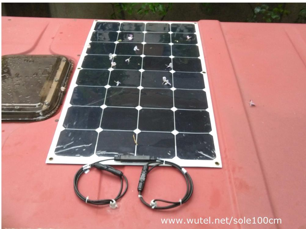
I cavi (+) e (-) dal pannello fotovoltaico al regolatore di carica, sono realizzati con del cavo unipolare di sezione 6mmq, intestato con gli appositi connettori a tenuta stagna tipo "[MC4](#)", utilizzati anche per realizzare una prolunga, nel caso il pannello non dovesse essere posizionato sul tetto del camper.
