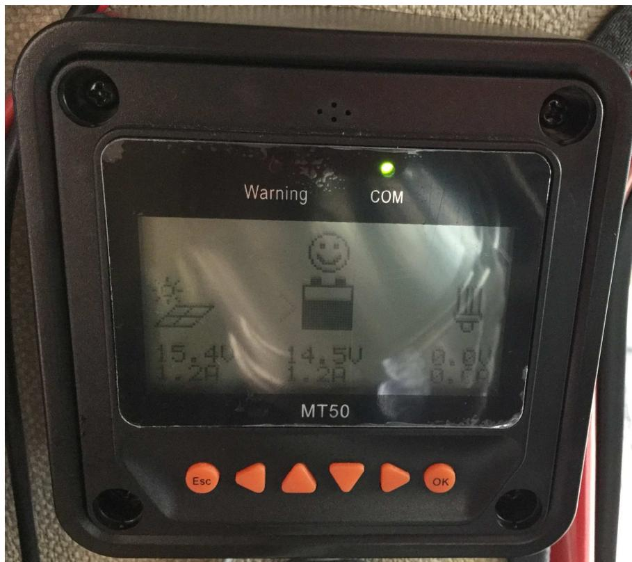
Il regolatore di carica consente di caricare correttamente le batterie a 12Volt. Questo particolare modello di regolatore di carica "PWM", grazie alle funzioni di programmazione attivabili con i tasti presenti sul display, permette di poter scegliere il tipo di batteria da caricare (ermetiche AGM o GEL, oppure ad acido libero), nonché attivare altre funzioni.
