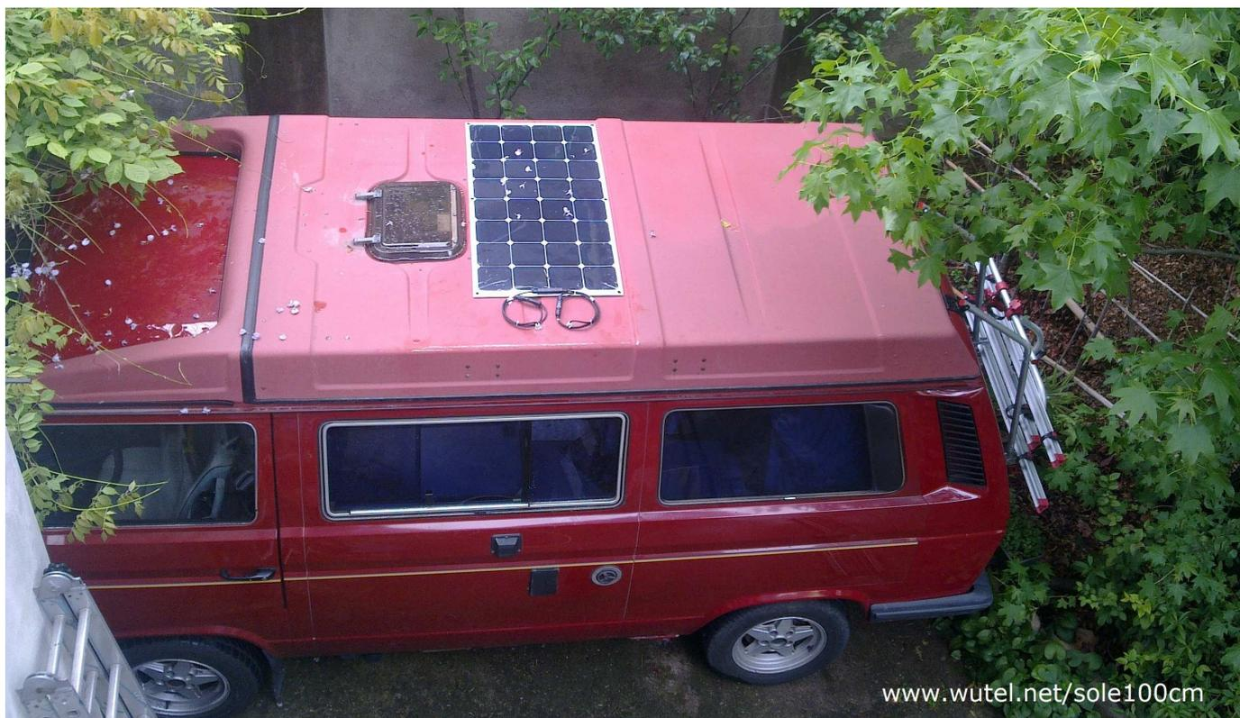
La particolarità di questa soluzione fotovoltaica è quella di utilizzare un pannello fotovoltaico flessibile e leggero (peso: 1,2Kg), fissato sul tetto in resina del camper tramite un sistema di ancoraggio rimovibile:
