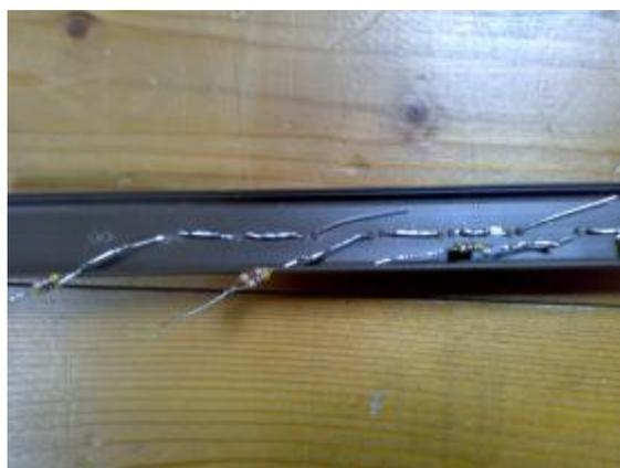
Inserire sulle resistenze degli spezzi di tubetto isolante (es. cannucce per bibite) per isolarle elettricamente dal resto del circuito.
