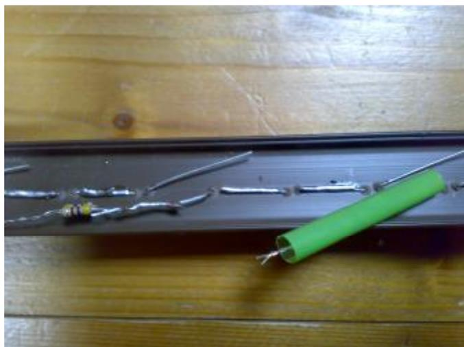
**Nota:** per la realizzazione di questa lampada sono state utilizzate resistenze da 470 ohm (1/4 watt) accoppiate tra loro in parallelo in modo da ottenere un valore complessivo di circa 220 ohm per ciascun gruppo di 3 LED (i LED in foto sono quelli da 10mm di diametro, 140.000mcd di luminosità e 20mA di corrente).
