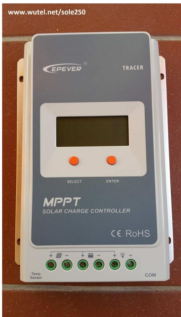
E' stato scelto questo specifico tipo di regolatore, in quanto soltanto i modelli tipo "MPPT" da 20A, sono in grado di poter gestire pannelli da 250Watt (24V), per la ricarica di batterie a 12Volt.
