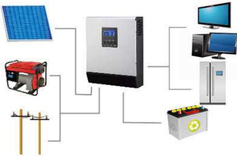
La peculiarità di questo inverter consiste nel poter alimentare gli apparecchi domestici a 230V, prelevando **l'energia necessaria prioritariamente dai pannelli e, soltanto se necessita, dalle batterie** (sempre comunque tenute in carica dai pannelli fotovoltaici e/o dalla rete o dal generatore a motore, se presenti).
