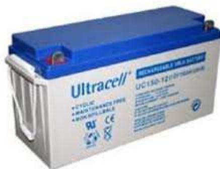
le batterie al piombo AGM sono adatte per gli impianti fotovoltaici ad accumulo poiché ermetiche, senza manutenzione, adatte inoltre a frequenti cicli di carica e scarica nonché garantite per un buon numero di anni di funzionamento. Le batterie sono necessarie per l'immagazzinamento dell'energia elettrica prodotta dai pannelli fotovoltaici e per l'alimentazione dell'inverter.
