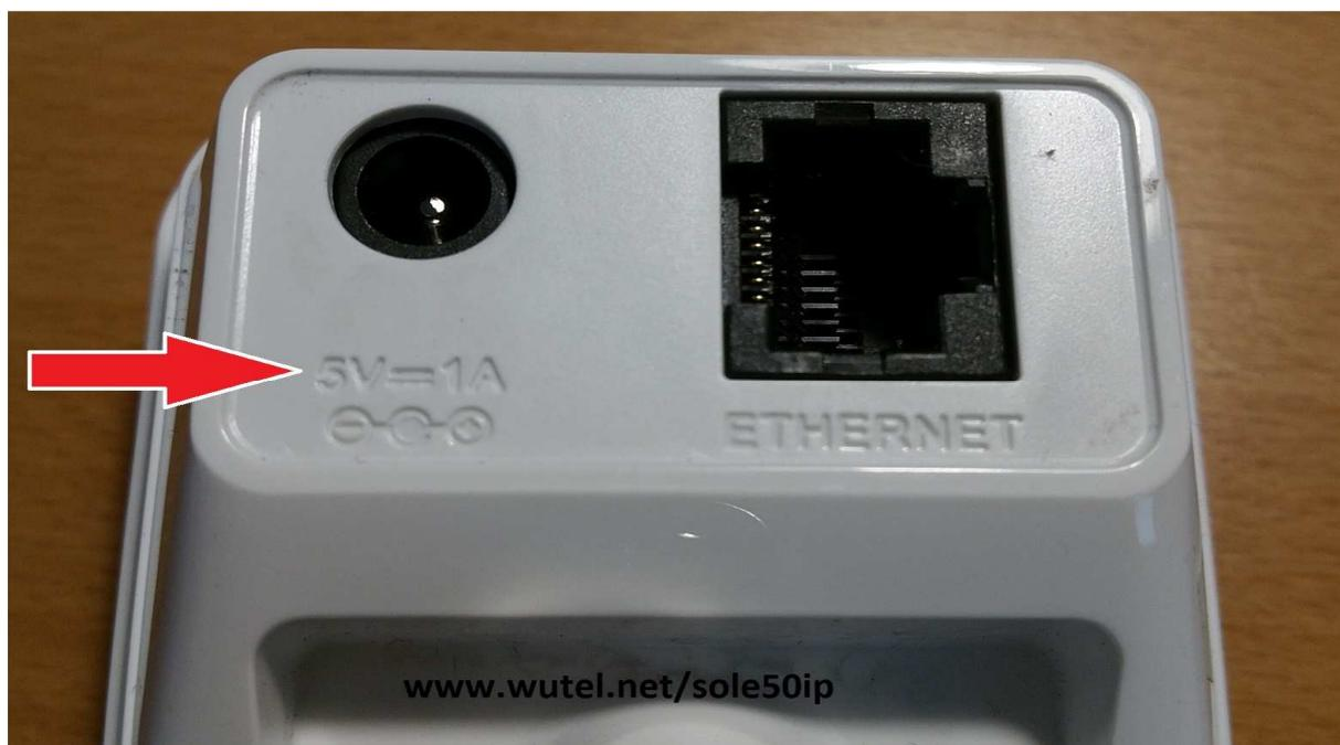
Quindi, siccome le prese USB hanno in uscita proprio una tensione di 5V e (previa verifica di portata), una corrente erogabile anche maggiore di 1A, è possibile collegare direttamente la telecamera a queste prese.
