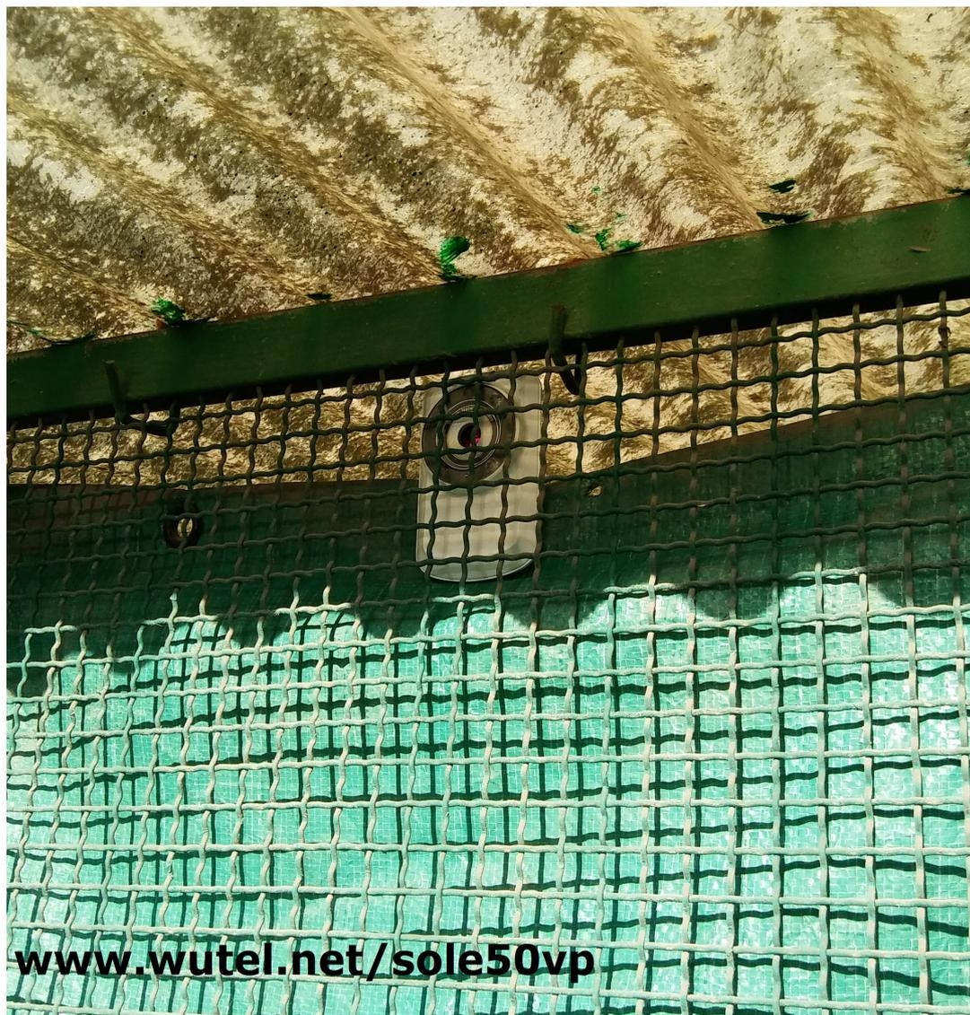
La telecamera utilizzata in questa applicazione, sfrutta per il collegamento ad internet una connessione WiFi a 2,4GHz che riceve da un modem/router distante 60 metri circa in linea d'aria (senza ostacoli in mezzo alle due apparecchiature).
