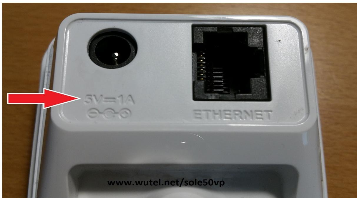
che, tramite l'apposito cavetto adattatore, reperibile con facilità su internet, permette di collegare direttamente la "IP CAM" ad una delle prese USB 5Volt presenti sul regolatore di carica.
