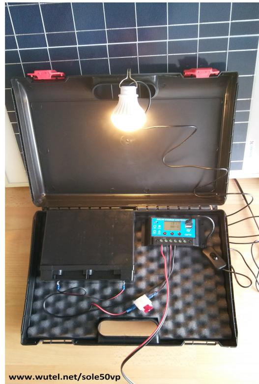
Per rendere ancor più agevole l'utilizzo portatile/mobile della valigetta, è anche stato inserito un connettore ad innesto rapido (tipo faston), per il collegamento elettrico del pannello fotovoltaico, in modo da non dover utilizzare il cacciavite per staccare e riattaccare ogni volta i cavi nei morsetti del regolatore di carica.
