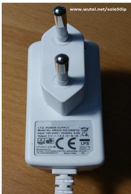
Come si vede dalle seguenti foto, sia l'alimentazione della telecamera IP che quella della centralina LAN, è di 5Volt.
