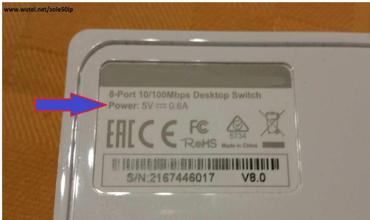
Questo permette così alla maggior parte delle apparecchiature che utilizzano internet, di poter funzionare indipendentemente dalla rete elettrica a 220/230Volt e, quindi, di risultare alimentabili direttamente e autonomamente con impianti fotovoltaici a batteria (senza inverter!).
