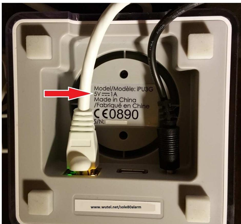
Quindi, siccome le prese USB del regolatore di carica utilizzato in questo impianto hanno in uscita proprio una tensione di 5Volt e una corrente erogabile di 2Ampere (max), è possibile collegare direttamente la centralina e la telecamera a queste due prese.
