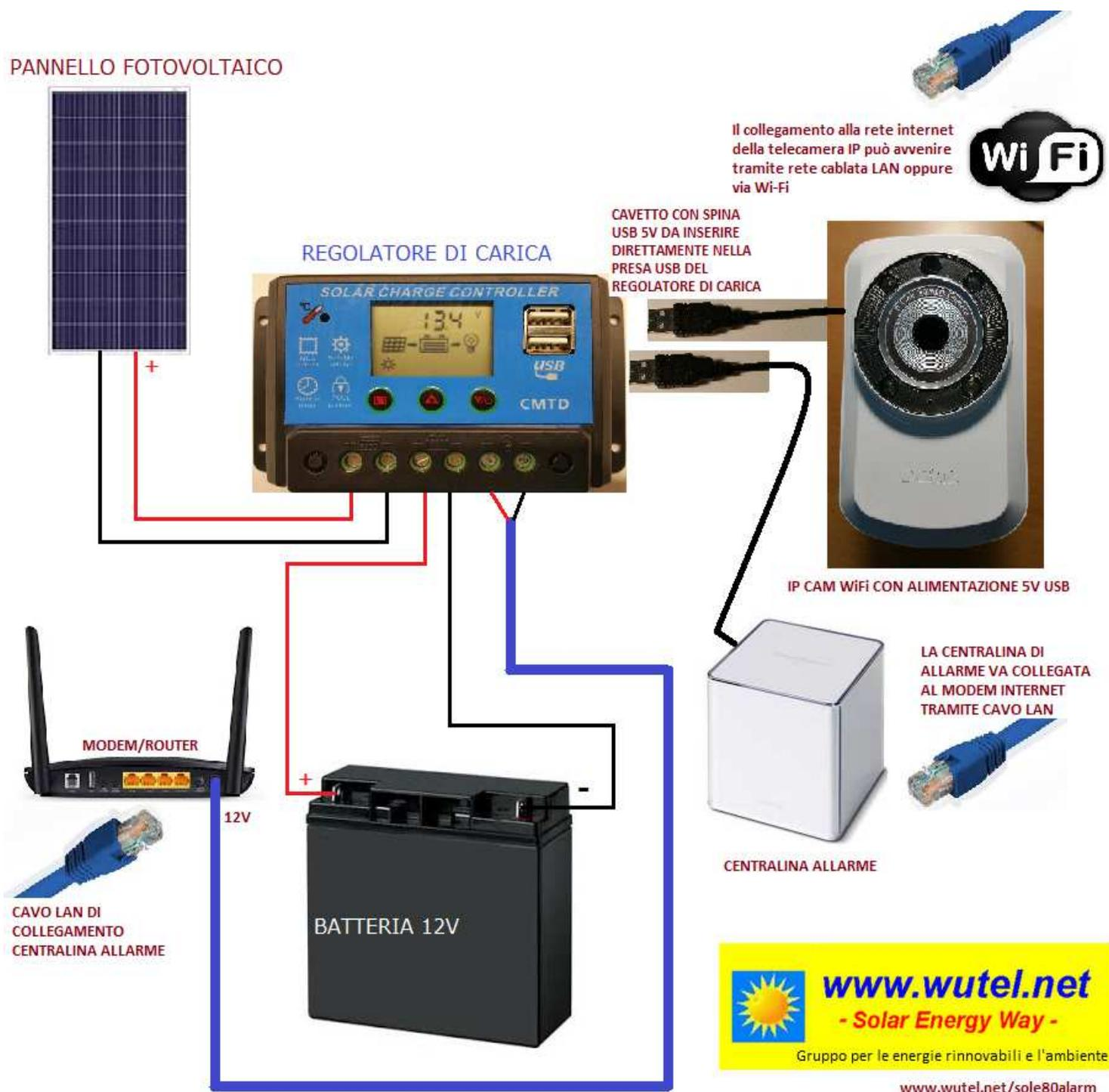
Il dimensionamento dei componenti (potenza del pannello "Watt" e capacità della batteria "Ah"), è stato calcolato in funzione della località di installazione dell'impianto (sud Italia) e dal fatto che tutte le apparecchiature possano funzionare 24 ore su 24, 7 giorni su 7, con un'autonomia di almeno 3 giorni in caso di giornate nuvolose, senza sole.
