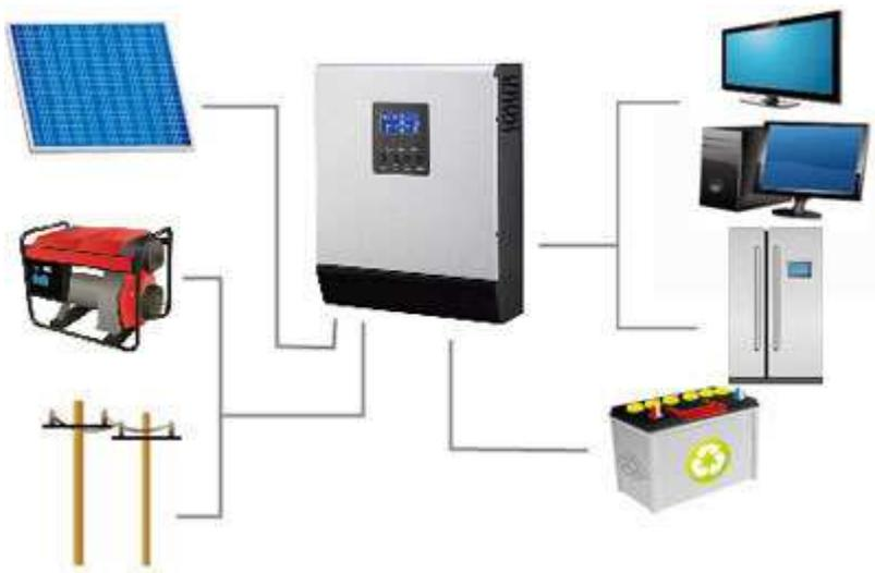
L'inverter consente di poter alimentare gli apparecchi domestici a 230Volt, prelevando l'energia occorrente dai pannelli fotovoltaici e/o dalle batterie a 24Volt.
