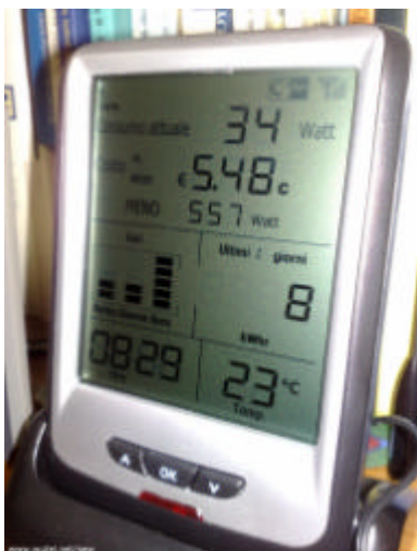
(5) Esempio di wattmetro portatile ad inserzione "a pinza" (dotato di display multifunzione senza fili)
