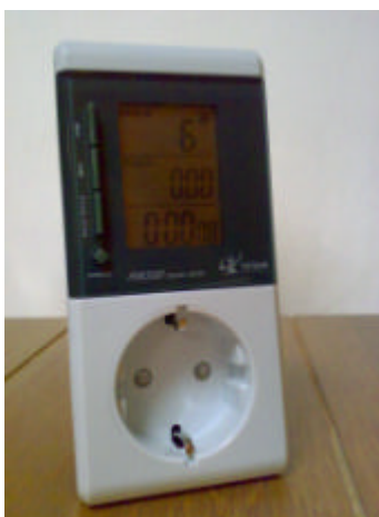
(4) Esempio di wattmetro/amperometro/voltmetro portatile ad inserzione diretta (misuratore dell'intensità di corrente, della tensione e della potenza elettrica)
