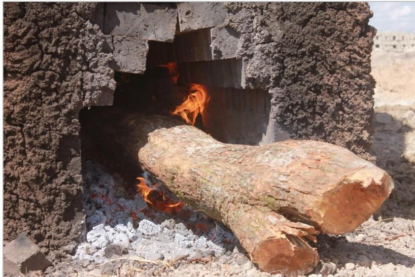
**Figura 5 Forno realizzato per la cottura dei mattoni**
