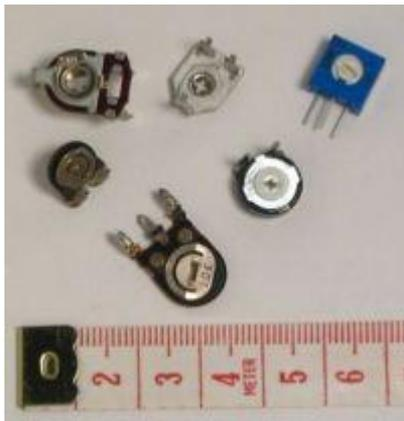
Vari tipi di trimmer per montaggio su circuito stampato di basso costo (e bassa precisione)
