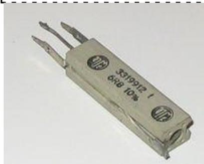
Resistore di valore resistivo 6,8 ohm, tolleranza 10%. La potenza sembra essere di non più di 10 watt
