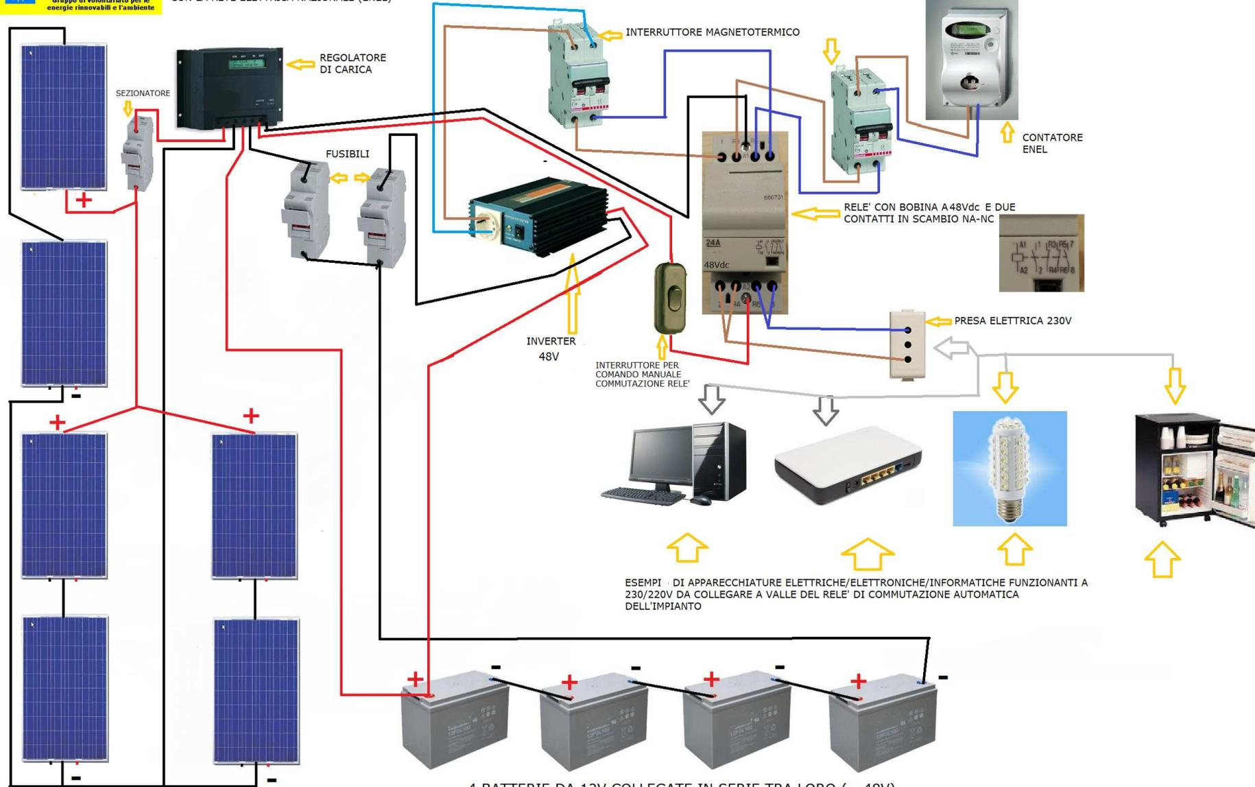
ESEMPI - DI APPARECCHIATURE ELETTRICHE/ELETTRONICHE/INFORMATICHE FUNZIONANTI A 230/220V DA COLLEGARE A VALLE DEL RELE' DI COMMUTAZIONE AUTOMATICA DELL'IMPIANTO
