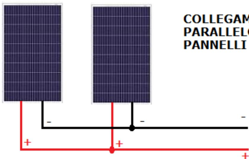
**COLLEGAMENTO IN PARALLELO DI DUE PANNELLI**
