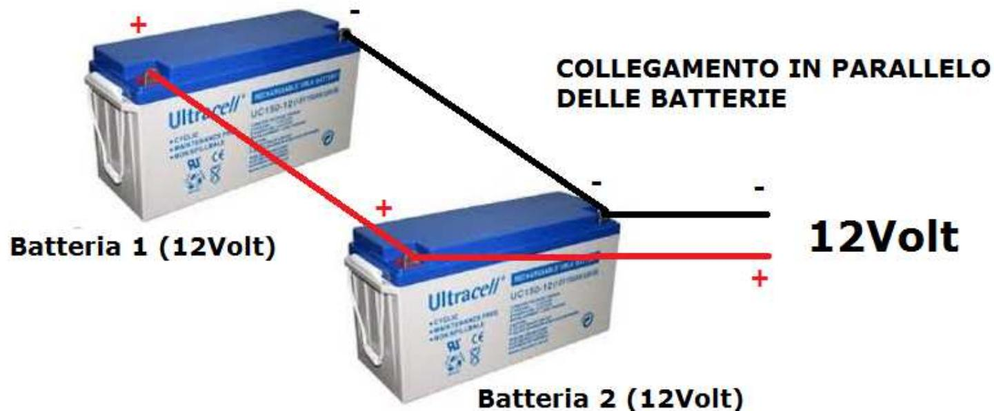
IN ENTRAMBI I COLLEGAMENTI (PARALLELO O SERIE), LE BATTERIE DEVONO ESSERE UGUALI (TENSIONE "V" E CAPACITA' "Ah")
