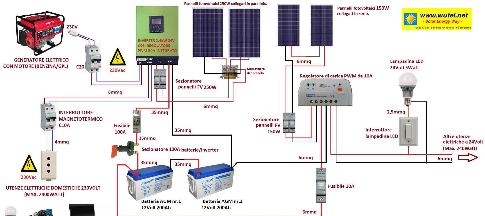
Le due batterie a 12Volt, sono collegate in serie tra loro in modo da avere una tensione totale dell'impianto a 24Volt.
