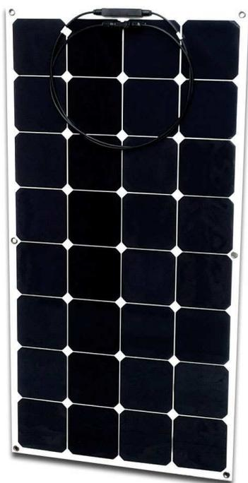
Pannello fotovoltaico flessibile monocristallino con celle "SunPower" ad alta efficienza (>20%) leggero, robusto, e calpestabile. Dotato di 6 occhielli di fissaggio, scatola giunzione anteriore e cavi intestati con connettori "multicontact".
