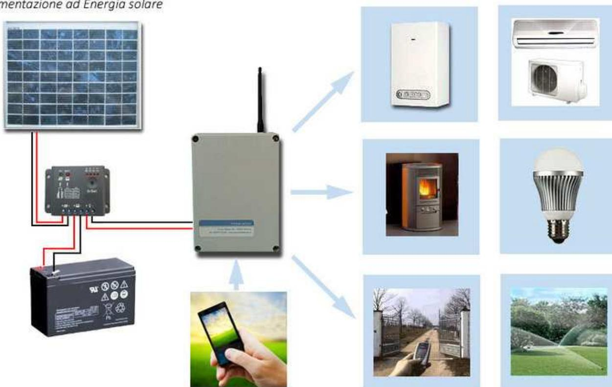
Dispositivo di telecontrollo a distanza (tramite rete telefonica cellulare GSM), funzionante a 12 Volt, **alimentabile ad energia solare**, in grado di comandare a distanza l'accensione e lo spegnimento di apparecchiature elettriche/elettroniche come ad esempio:
