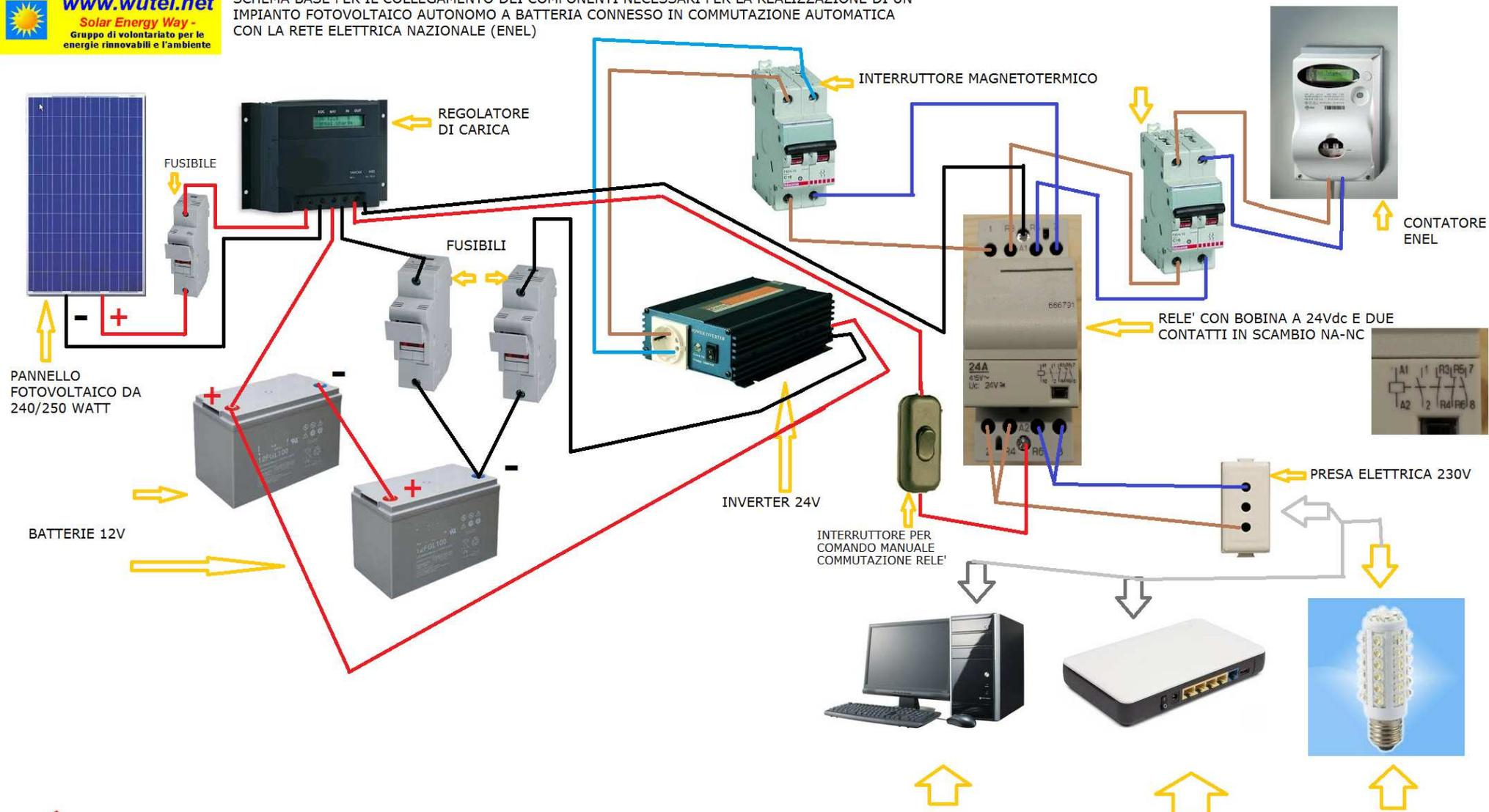
ESEMPI DI APPARECCHIATURE ELETTRICHE/ELETTRONICHE/INFORMATICHE FUNZIONANTI A 230/220V DA COLLEGARE A VALLE DEL RELE' DI COMMUTAZIONE AUTOMATICA DELL'IMPIANTO
