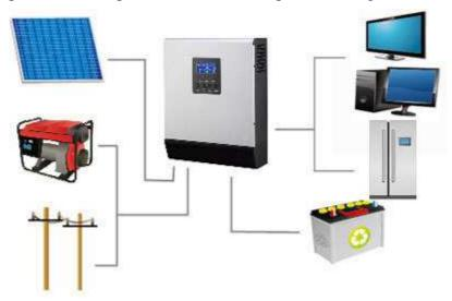
La peculiarità di questo inverter consiste nel poter alimentare gli apparecchi domestici prelevando **prioritariamente l'energia dalle batterie** tenute in carica dai pannelli fotovoltaici, e commutando automaticamente sulla rete elettrica solo nell'eventualità le batterie si scarichino, ad esempio in periodi di maltempo prolungato, o nella stagione invernale.
