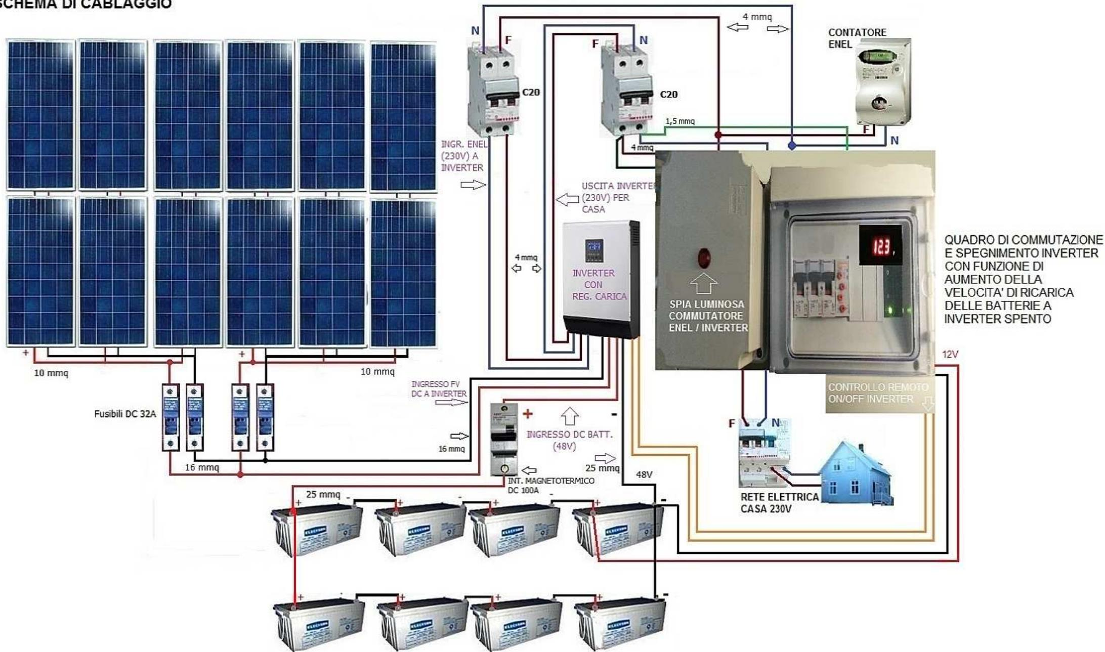
**N.B.** durante l'esecuzione dei collegamenti elettrici rispettare le polarità "+" e "-" dei cavi in corrente continua (DC) e fase (F), neutro (N) dei cavi in corrente alternata (AC) 230V indicate sui morsetti delle apparecchiature dell'impianto.
